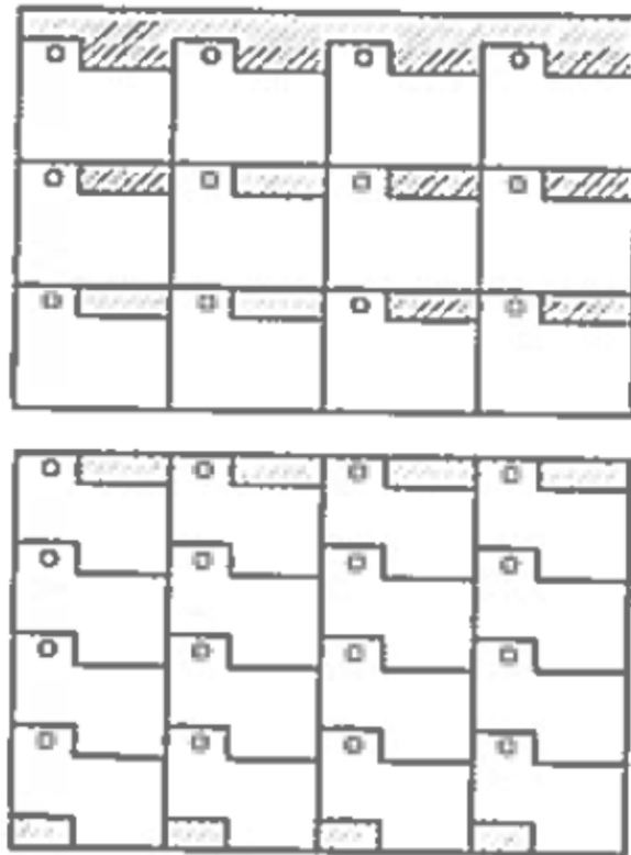
Materialeinsparung durch anordnungsoptimierte Teilgestaltung
