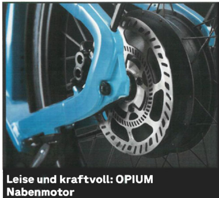
Abbildung 1: Kombinationsstruktur aus Fahrradrahmen und Motornabe
